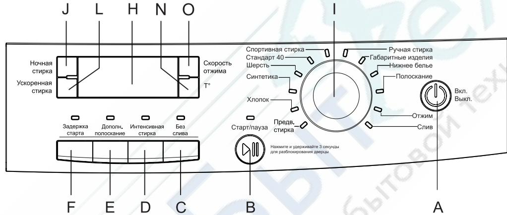
A — кнопка включения или выключения стиральной машины.
